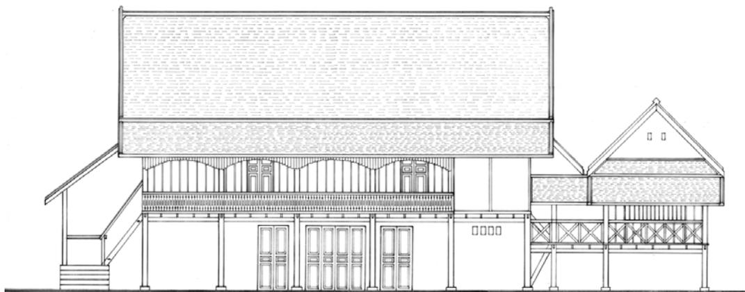
Occupation du rez-de-chaussée après l'ajout de murs maçonnés entre les pilotis
